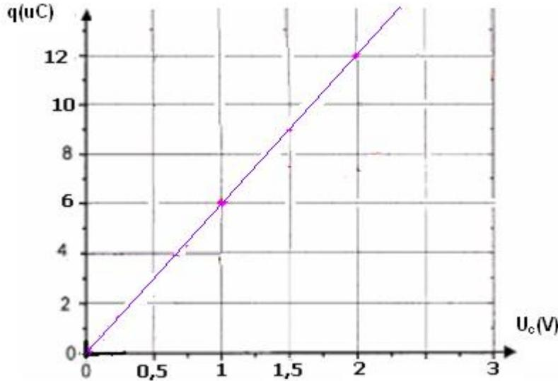
تناسب شحنة المكثف مع التوتر المطبق بين مربطيه و معامل التناسب بينهما ثابتة تميز المكثف ، تسمى: سعة المكثف. ويرمز إليها بـ C
