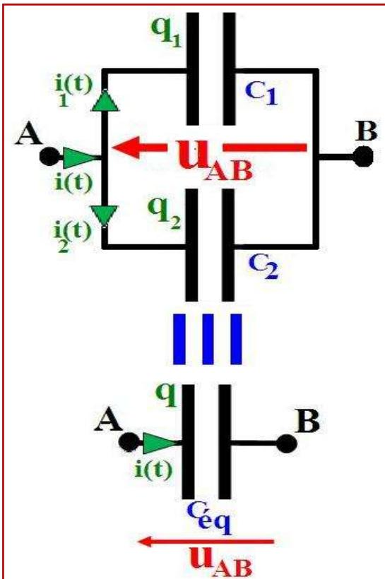
نركب مكثفين على التوازى سعاتهما  $C_1$  و  $C_2$ ، فيطبق بين مربطيهما نفس التوتر  $u_{AB}$ ، و بتطبيق قانون العقد فإن  $q=q_1+q_2$  كما أن:  $q=C_{eq}.u_{AB}$  و  $q_2=C_2.u_{AB}$  و  $q_1=C_1.u_{AB}$  سعة المكثف المكافأ لهذا التركيب ، و بتعميض كل شحنة بتعبيره نجد:  $C_{eq}=C_1+C_2$  و منه فإن:  $C_{eq}.u_{AB}=C_1.u_{AB}+C_2.u_{AB}$
