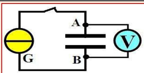
نعتبر التركيب التجاريبي الممثل جانبة و المكون من مولد مؤتمث للتيار، مكثف، فولطmeter رقمي، و قاطع تيار.
