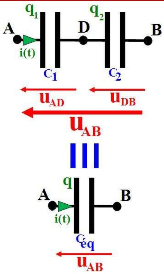
نركب مكثفين على التوالى سعاتهما  $C_1$  و  $C_2$ ، فيمر فيهما نفس التيار الكهربائى فيشحنا بشحنتين متساوين بحيث:  $q_1=q_2=q$  وبتطبيق قانون إضافية التوترات فإن  $u_{AB}=u_{AD}+u_{DB}$  كما أن:  $u_{AB}=\frac{q}{C_{eq}}$  ، حيث  $u_{DB}=\frac{q_2}{C_2}$  و  $u_{AD}=\frac{q_1}{C_1}$  سعة المكثف المكافأ لهذا التركيب ، و بتعمิض كل توتر بتعبيره نجد:  $\frac{1}{C_{eq}}=\frac{1}{C_1}+\frac{1}{C_2}$  و علما أن:  $q_1=q_2=q$  فإن:  $\frac{q}{C_{eq}}=\frac{q_1}{C_1}+\frac{q_2}{C_2}$
