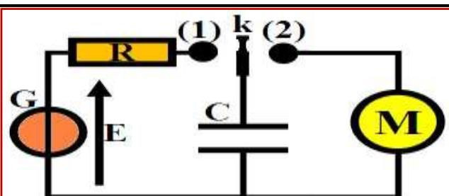
نعتبر التركيب التجريبي جانبه، و المكون من مكثف سعته  $C$  و موصل أومي مقاومته  $R$  و محرك  $M$  و مولد  $G$ . نضع قاطع التيار  $k$  في الموضع (1) حتى يشحن المكثف كلياً ثم نورجح قاطع التيار إلى الموضع (2)، فيشتغل المحرك لمدة زمنية.
