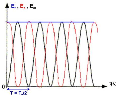
$$E_e = \frac{1}{2} Cu^2 \quad \text{مع} \quad U = E \cos\left(\frac{2\pi}{T_0} t\right) \quad \text{تعبير } E_e \text{ بدلالة الزمن : } \quad \text{هام}$$
