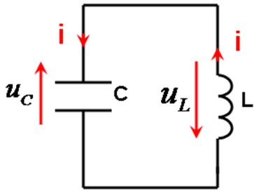
المعادلة التفاضلية التي يحققها التوتر  $u_C(t)$  :  $\frac{d^2u_C}{dt^2} + \frac{1}{LC} u_C = 0$
