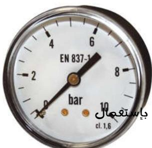
جهاز المانومتر Manomètre. الوحدة العالمية لقياسه هي **الباسكال** يرمز لها ب **Pa**.
