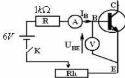
بعد إغلاق قاطع التيار الكهربائي نقيس تغيرات تيار دارة القاعدة بدلالة تغيرات التوتر  $U_{BE}$  فنحصل على المحنى التالي :
