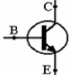
الوصلة هي المنطقة الوسيطة التي تفصل بين منطقتين مختلفتي التنشيط. ويرمز للترانزستور NPN في دارة كهربائية بالرمز التالي:
