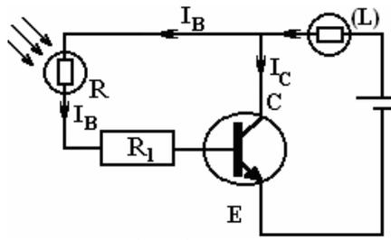
يتم التحكم في إضاءة المصباح  $L$  (الذي يلعب دور جهاز الاستعمال في هذا التركيب) بواسطة إضاءة المقاومة الضوئية (التي تلعب دور اللاقط أي جهاز التحكم) .
