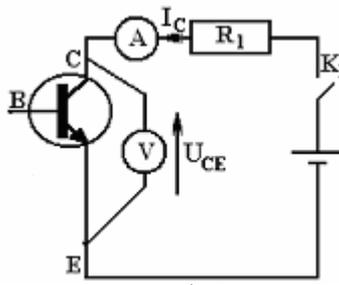
تبين التجربة انه لا يمر أي تيار كهربائي في الدارة كلما كانت قيمة التوتر  $U_{CE}$  يعني أن الوصلة CE تتصرف كقاطع تيار مفتوح.
