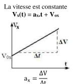
V<sub>0x</sub>: la coordonnée du vecteur vitesse sur l'axe Ox à l'instant t= 0 Equation horaire du mouvement  $x(t) = \frac{1}{2} a_x t^2 + V_{0x} t + x_0$
