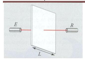
On enregistre l'amplitude u<sub>m</sub> du signal détecté par R.
