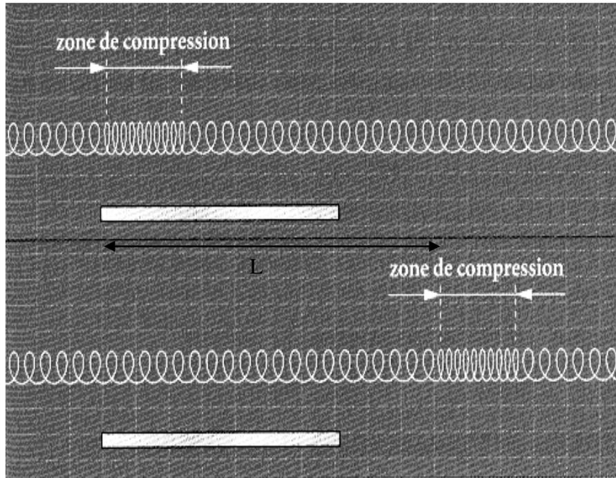
Sur la photo la distance  $L$  est représentée par un segment de longueur 4,2 cm. La règle de 1,0 m est représentée par un segment de longueur 3,0 cm. On en déduit  $L = 1,4 \text{ m}$ .
