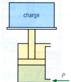
**Exercice 4 :** Calculer les efforts théoriquement développables, en poussant et en tirant, d'un vérin ( $D = 100 \text{ mm}$  et  $d = 25 \text{ mm}$ ) si la pression d'utilisation est de **500 kPa (5 bars)**.
