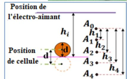
Alors on peut calculer sa **vitesse** par la **relation  $V = \frac{d}{\Delta t}$**  avec  $d = 1,8\text{ cm}$  le **diamètre** de **bille**.
