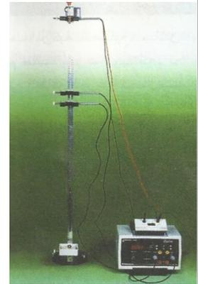
s'arrête lorsque l'**extrémité supérieure** de la **bille** dépasse ce **rayon**. Ainsi, On peut déterminer la **durée  $\Delta t$**  qui prend le **passage** de la **bille** devant la **cellule**.
