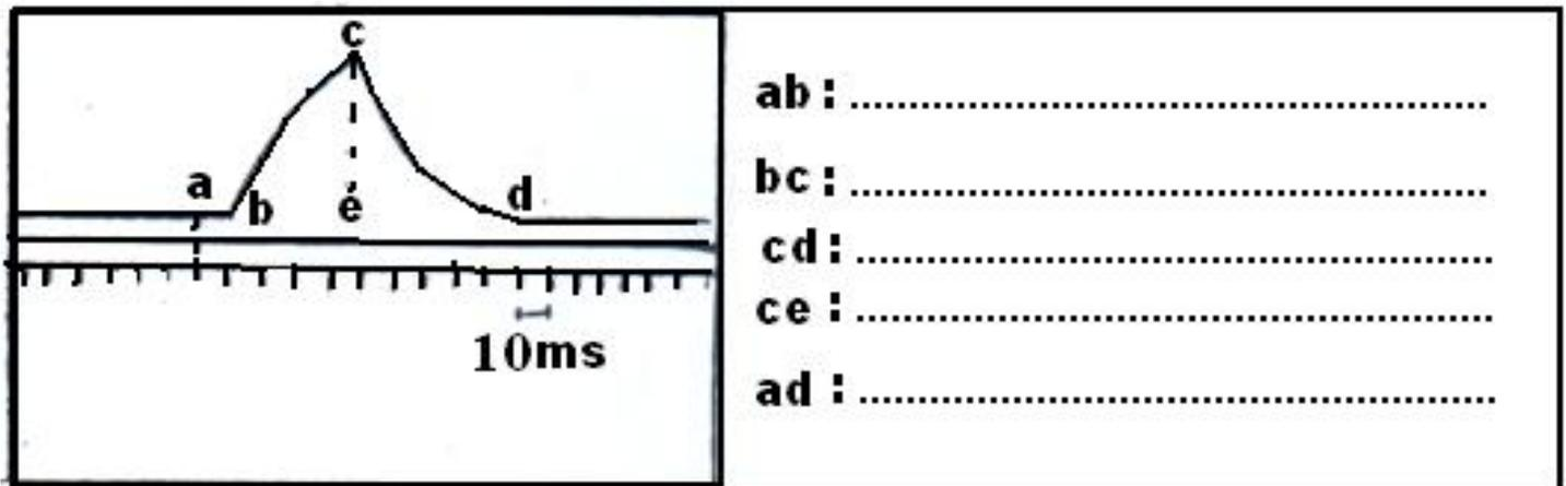
La secousse musculaire est asymétrique la durée de la phase de contraction est plus courte que la durée de la phase du relâchement .
