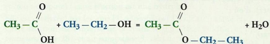
L'ion  $\text{H}^+$ , fourni par l'acide sulfurique, accélère la réaction sans figurer dans son équation : c'est un **catalyseur**<sup>1,2</sup>.
