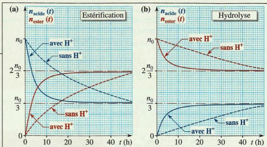
Doc. 6 Influence des ions  $H^+$  sur l'équilibre d'estérification – hydrolyse, dans le cas où le système initial est constitué d'un mélange équimolaire : (a) d'alcool et d'acide ; (b) d'ester et d'eau.
