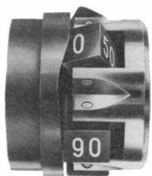
Cela est rendu possible grâce à 5 dés montés dans une cage où ils se meuvent en suivant une came de guidage. Lors de la rotation du tambour, ils tournent autour de leur axe et laissent ainsi apparaître les valeurs correspondantes au  $1/10^{\text{ème}}$  dans une fenêtre du tambour.
