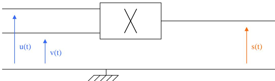
La multiplication de deux tension (avec un coefficient de multiplication) donne une nouvelle tension, appelée **signal modulé**, et dont l'amplitude maximum varie comme le signal modulant. La fréquence est celle du signal porteur.
