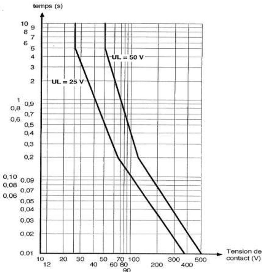
Selon le type de local, la norme NFC 15-100 précise, pour une tension d'alimentation en courant alternatif, deux valeurs de tensions limites conventionnelles de sécurité  $U_L$  :
