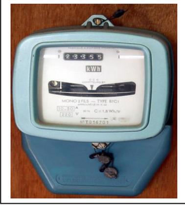
**(II) قياس الطاقة الكهربائية المستهلكة في تركيب منزلي :**
