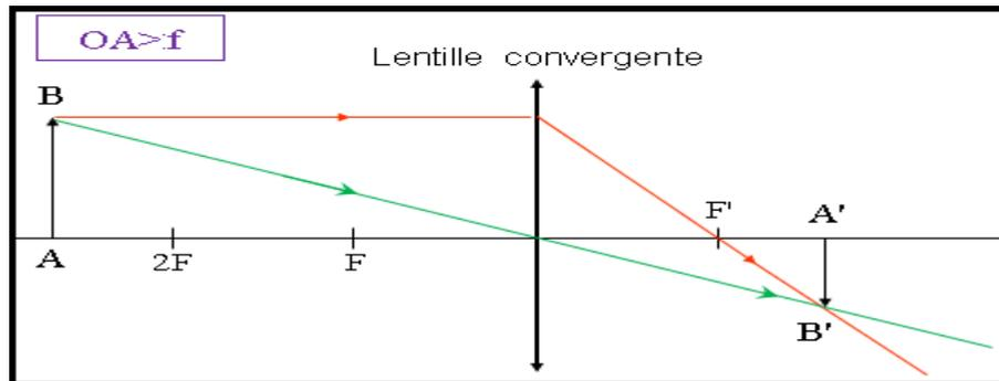
L'image **A'B'** réelle renversée par rapport à l'objet et la taille de l'image **A'B'** varie en fonction de la position de l'objet **AB** sur l'axe optique.
