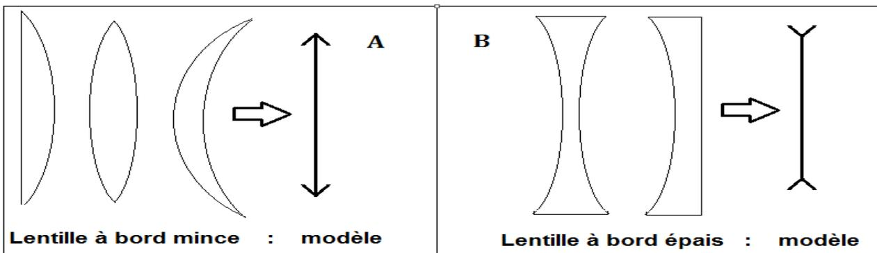
**B. Activité 2 :** On envoie 3 rayons parallèles vers 2 lentilles différentes, une Lentille à bords mince  $L_1$  et l'autre à bords épais  $L_2$ . Voir le schéma et compléter le tableau suivant :
