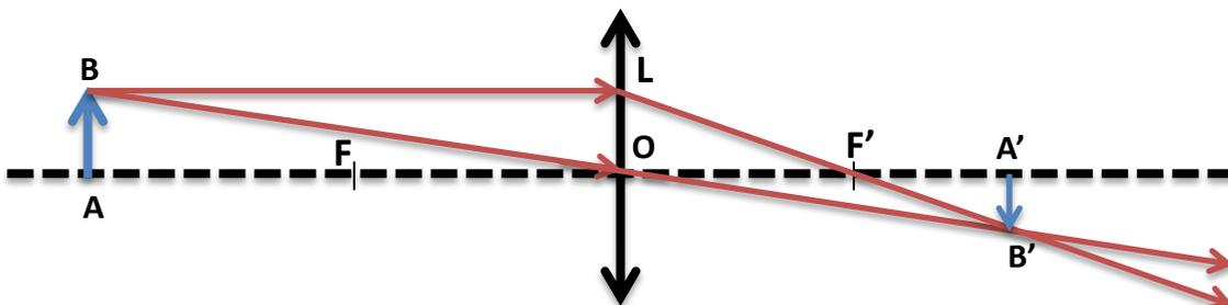
Le point d'intersection de ces deux rayons est  $B'$ , image de  $B$  par la lentille convergente.
