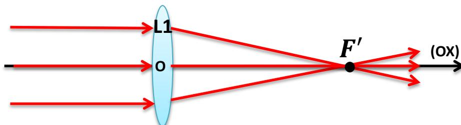
Envoyer un faisceau de lumière parallèle sur une lentille convergente  $L_2$ . Observer
