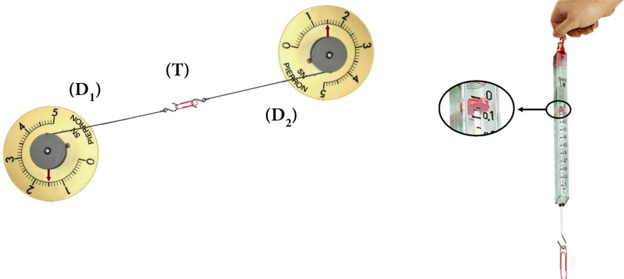
On a :  $P = 0,025 \text{ N}$  et  $F_1 = F_2 = 1,5 \text{ N}$
