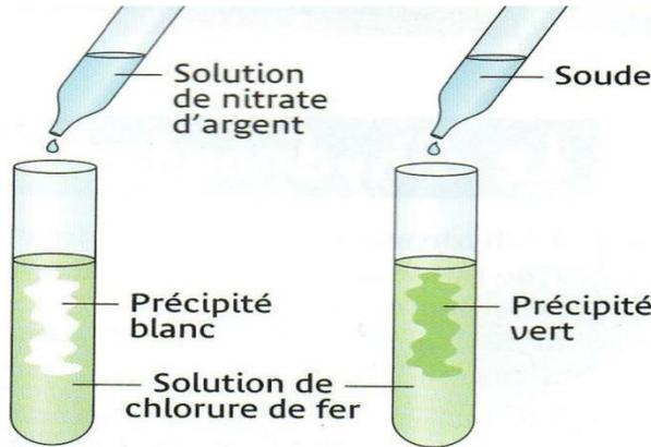
Test à la soude: il se forme un précipité vert qui caractérise la présence d'ions fer<sup>II</sup>: Fe<sup>2+</sup>.
