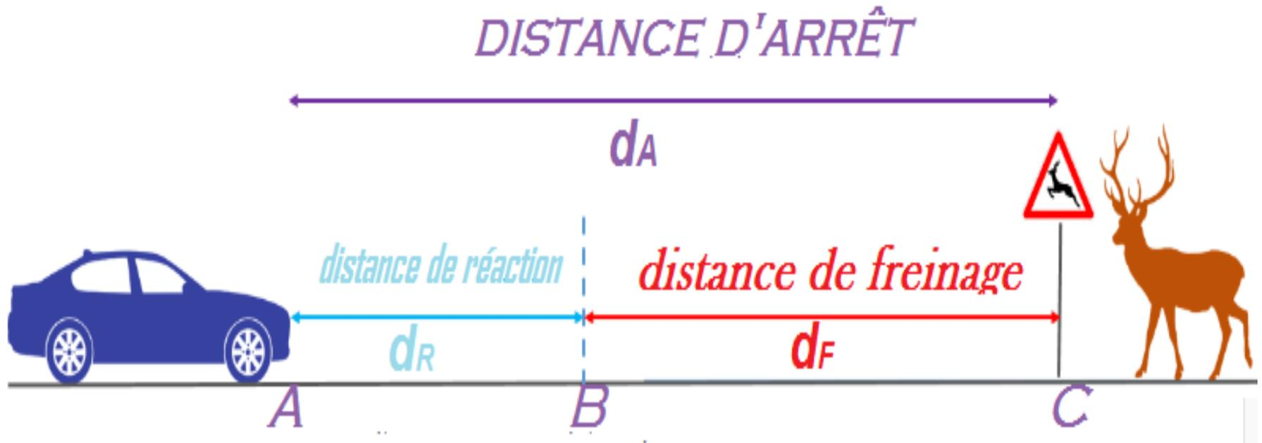
la distance d'arrêt  $d_A$  est la somme de la distance de réaction  $d_R$  et la distance de freinage  $d_F$  .
