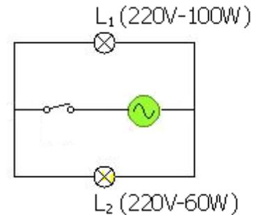
Comparer les éclairagements des lampes L1 et L2 avec les indications en watt (W) portées sur les culots.
