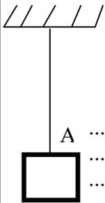
يمثل الشكل جانبه جسم (S) متجانس (مربع)، شدة وزنه  $P=10N$  يوجد في حالة توازن معلق بواسطة خيط.
