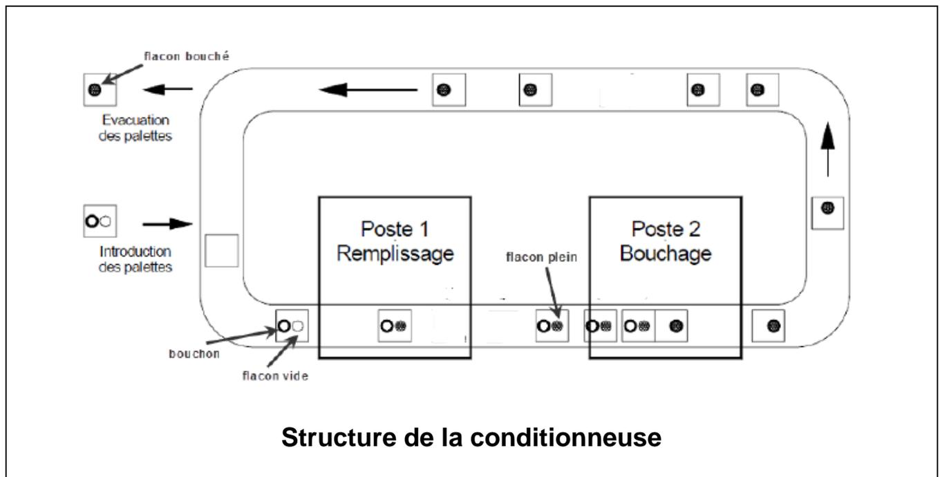
**Structure de la conditionneuse**
