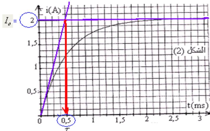
$$\tau = 0,5ms \quad \text{و:} \quad I_o = 2A \quad \text{نجد مبيانا:}$$
