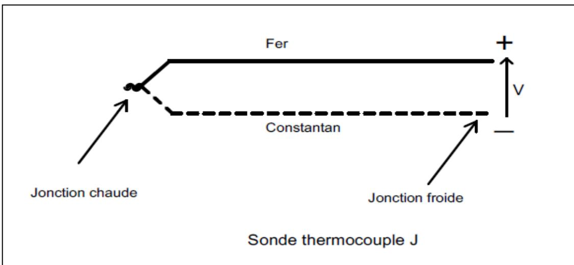
**Q2:** La grandeur physique d'entrée du capteur : La température. 0,5 pt
