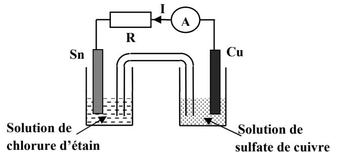
On relie les électrodes de la pile à un conducteur ohmique en série avec un ampèremètre. On observe le passage d'un courant électrique d'intensité  $I$  constante, de l'électrode de cuivre vers l'électrode d'étain, dans le circuit extérieur. (voir schéma ci-dessus)
