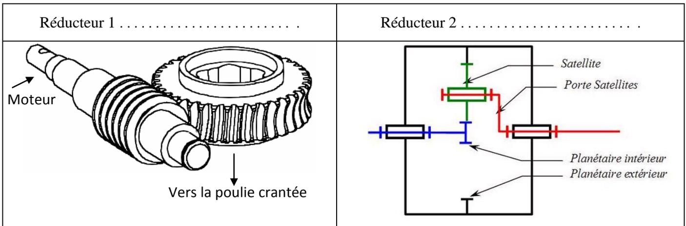
b) Lorsqu'une coupure de courant survient, la porte étant fermée, peut-on l'ouvrir dans le cas où elle est équipée d'un réducteur irréversible ?
