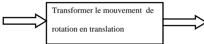
Nature de l'énergie à la sortie : Energie mécanique de translation continue
