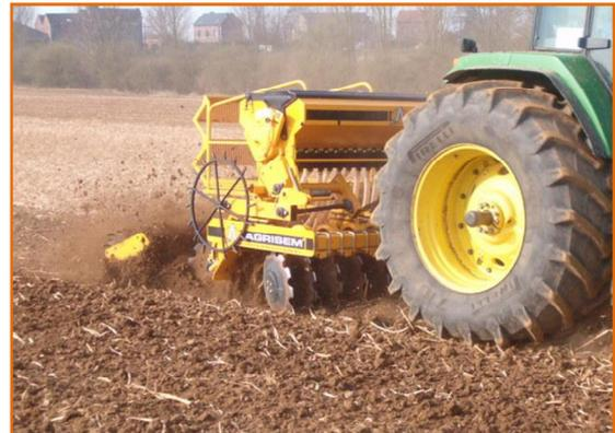
Photo n°2: Déchaumeuse à disques
