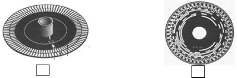
**Q.22.** Confirmation ou négation quant au pouvoir du codeur de résolution  $R = 500$  **impulsions/tour** à mesurer la position de la table avec la précision de 0,01 mm. 0,25 pt
