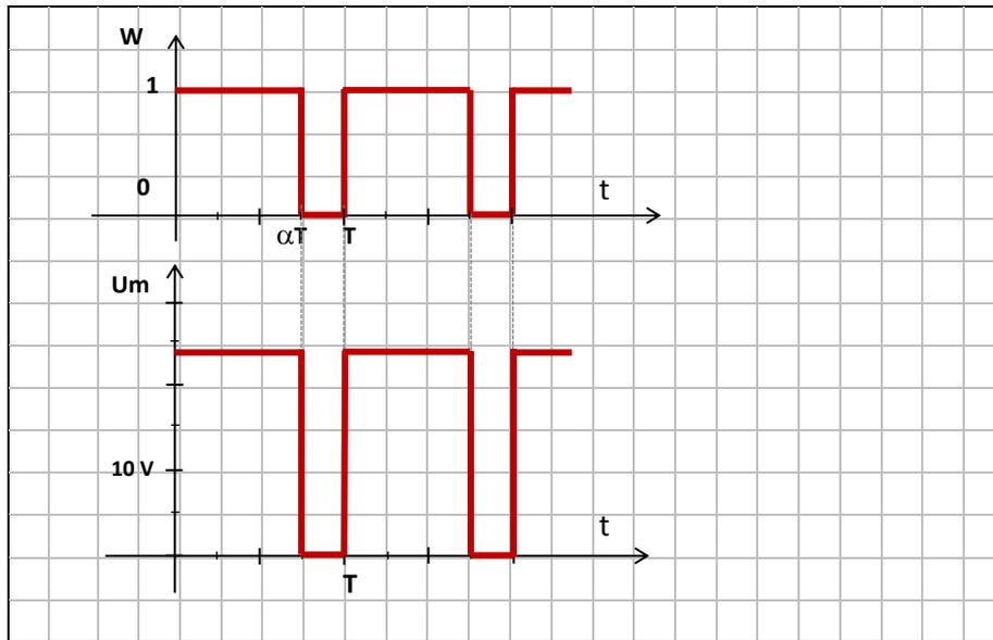
Q.14. Tension moyenne V<sub>ABmoy</sub> aux bornes du moteur M1 et vitesse de rotation Nm1 (en tr/min).
