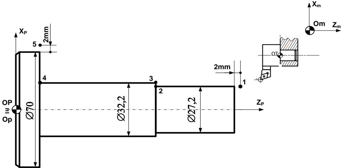
b. Compléter le tableau des coordonnées du profil ébauche (points 1 à 5) en mode absolu G90, en tenant compte des dimensions indiquées sur la figure ci-dessus et en utilisant le DRESS (page 18/18) : /1,75pt
