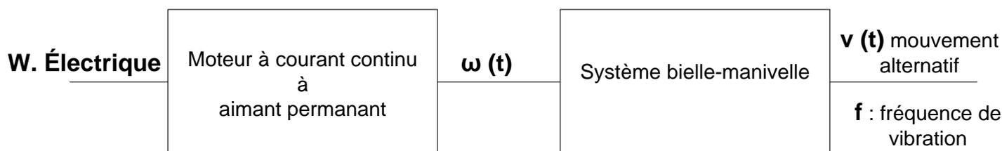
Le mouvement de vibration de la lame est caractérisé par une amplitude  $c$  (course de la lame) et une fréquence de vibration  $f$ .
