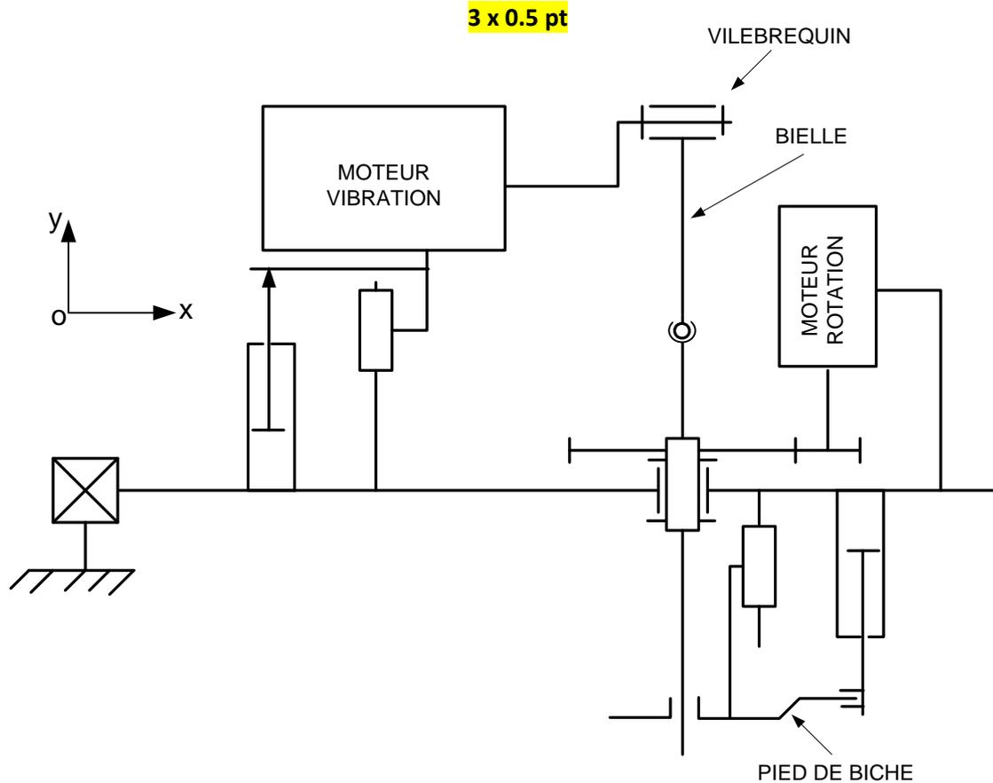
2.3.2 On a utilisé la liaison rotule entre la bielle et le guide-lame parce qu'il faut une rotation autour de l'axe horizontale ( $ox$ ) de la bielle et une autre autour de l'axe vertical ( $oy$ ) permettant au guide lame de tourner pour suivre la trajectoire de coupe. **0.5 pt**
