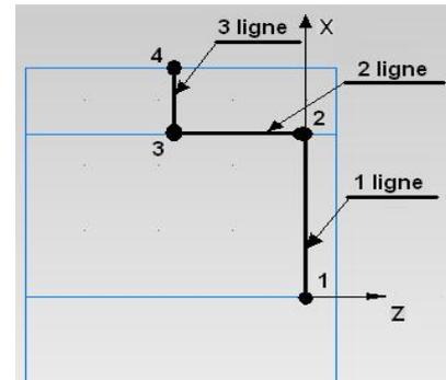
Nota : Usinage de face **a=2mm** ;
