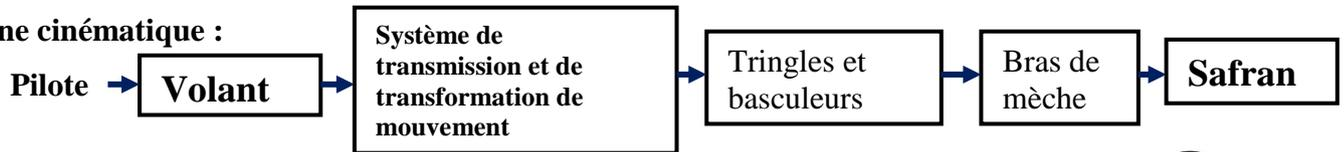
Schéma du système de direction mécanique :
