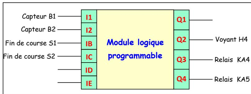
Configuration des entrées/sorties au niveau du module logique programmable
