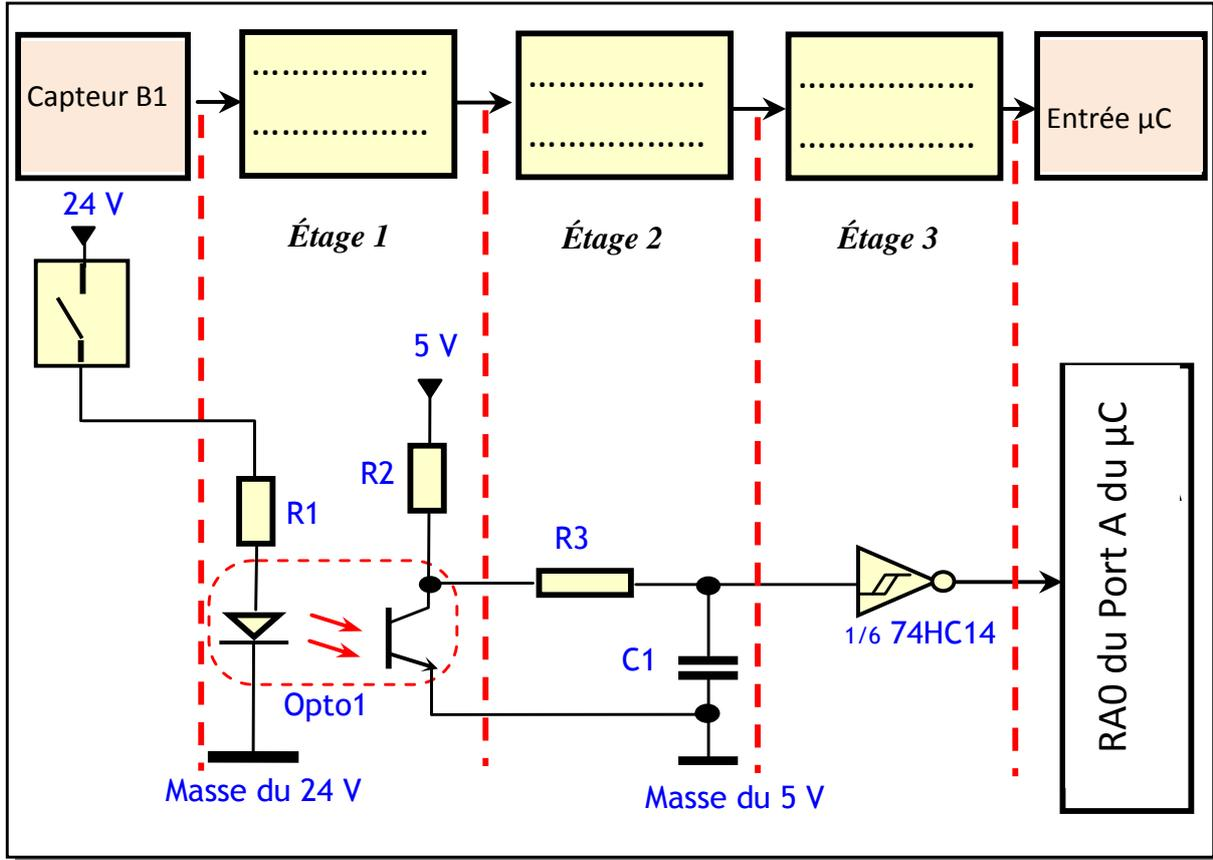
NB : Le capteur photoélectrique est symbolisé par un simple contact
