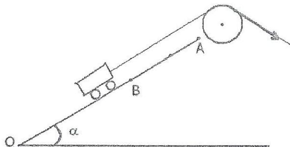
On néglige les frottements et on prend  $g = 9,8 \text{ m.s}^{-2}$ . On tire un chariot avec un fil non extensible et ayant une masse nulle, autour d'un cylindre de masse  $m_c = 250 \text{ g}$  et de rayon  $r = 6 \text{ cm}$ .
