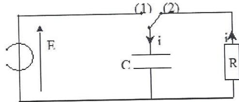
**Question 7 :** donner l'équation différentielle vérifiée par la tension  $u_C$  aux bornes du condensateur.
